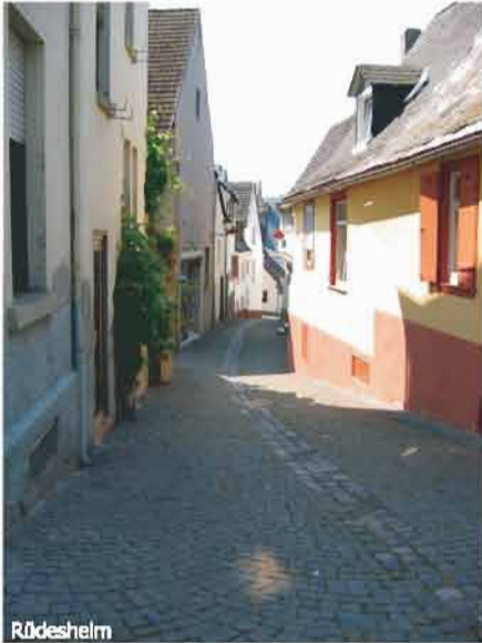
Einheitliche, ruhige Gestaltung von Hauswand zu Hauswand mit mittiger Pflasterrinne
