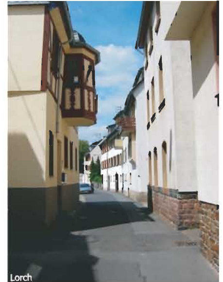
Der Erker markiert den Abzweig der Gasse, betont die Engstelle im Straßenraum und gliedert damit die Straße in begrenzte Raumabschnitte
